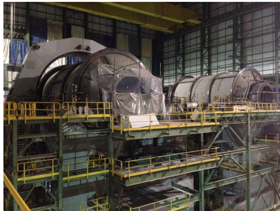
Статор для шаровой мельницы II с безредукторным приводом и шаровая мельница I
